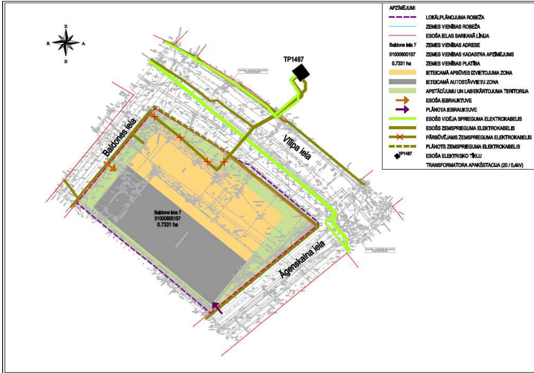
77. attēls. Plānotās elektroapgādes shēma
